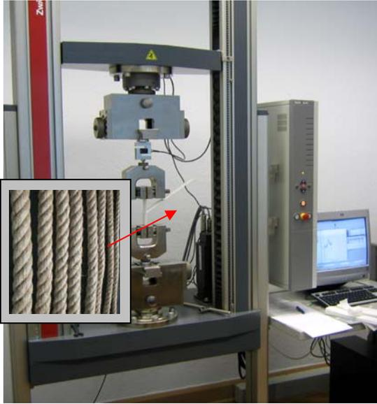
Abb. 2: Zwick Z100 Materialprüfmaschine zur Bestimmung der Reißfestigkeit
