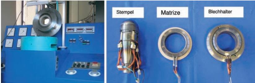
**Abbildung 2:** Blechprüfmaschine „Erichsen“ mit beheizbaren Aktivteilen
