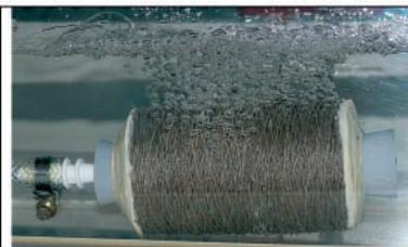
**Abbildung 2:** Blasenbild einer kreuzbespulten Garnwickel-Filterpatrone
