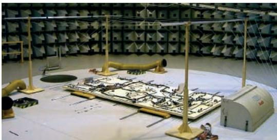
**Abbildung 2:** EMB unter der Fahrzeugstreifenleitung
