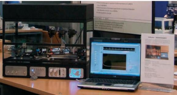
**Abbildung 1:** Multiwellenlängen cavity-ring-down-Messplatzes (Ausstellung auf Lasermesse, München, Juni 2007)
