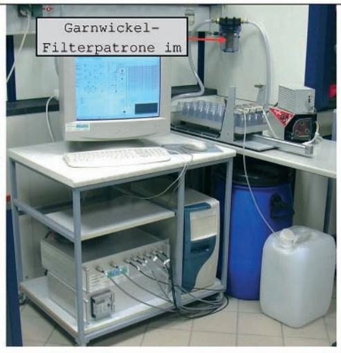
**Abbildung 4:** Laborversuchsanlage zur Testung der Filterpatrone im 5-Zoll-Maßstab
