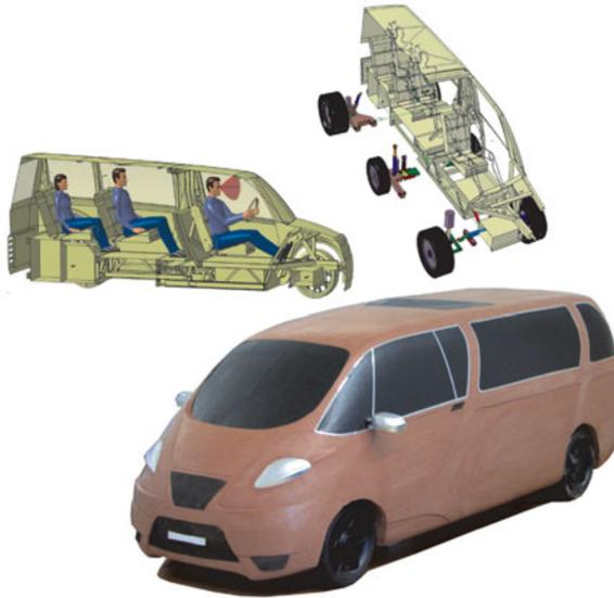
**Abbildung 5:** Skizzen und Modell des Modulfahrzeugs
