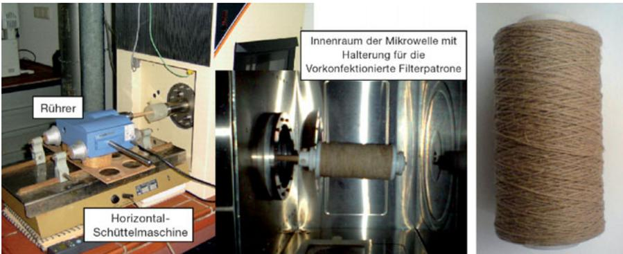
**Abbildung 5:** Modifizierte Mikrowellenanordnung (links) für die Phosphorylierung von vorkonfektionierten Garnwickel-Filterpatronen aus Naturfasermaterialien (rechts)
