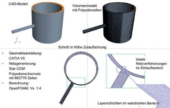
**Abbildung 15:** Digitalisierung des Experiments vom CAD-Modell zum Rechengitter
