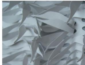
**Abbildungen 18:** Siebdruck in Kombination mit Wasserstrahlschneiden
