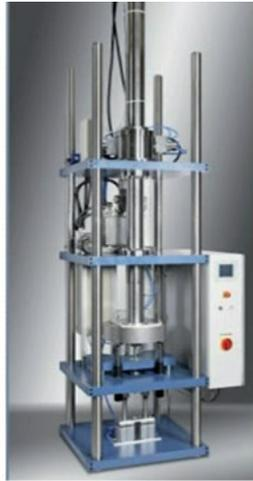
**Abbildung 19:** Hochgeschwindigkeits-Prüfstand
