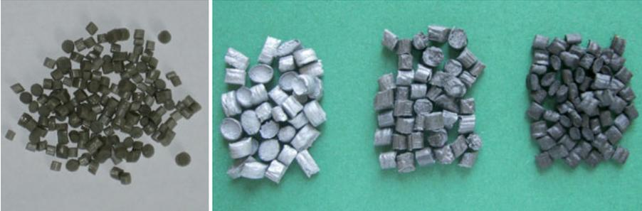
**Abbildung 20:** Primäres Granulat aus Altpapierfasern und Kartoffelstärke links und mit verschiedenen Füllstoffen extrudierte Granulate rechts. Der elektrische Widerstand wurde hier bei bis in den  $k\Omega$  – Bereich gesenkt.
