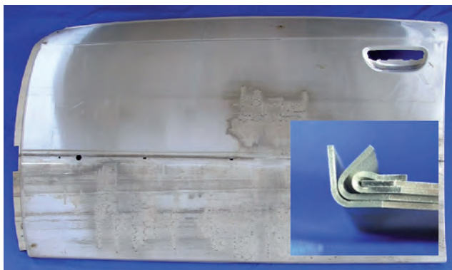
Abb. 3: Außenblech der Pkw-Rohbautür und Falzstufen
