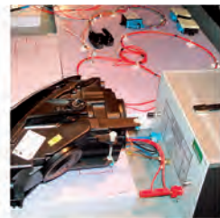
Abb. 1: links: Messaufbau für Störaussendung inkl. HiL-Simulator oben: Scheinwerfer und Bordnetznachbil- dung (BNN)
