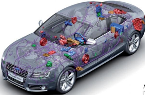
**Abb. 8:** Vernetzte Elektronik im Fahrzeug [Quelle: AUDI AG]
