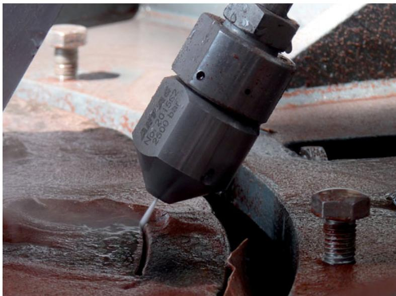
**Abb. 14:** 12 cm starke Glockenbronze, Schnitt mit Wasserstrahl
