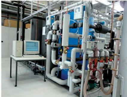
**Abb. 1:** Prüfstand zur Untersuchung von Wasser-Wasser-Wärmeübertragern
