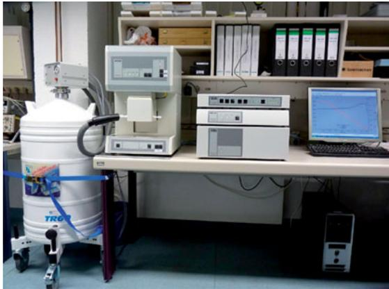
**Abb. 6:** Dynamisch-Mechanischer Analysator DMA242 C/1/G mit Tieftemperaturkühlung von NETZSCH Gerätebau GmbH Selb
