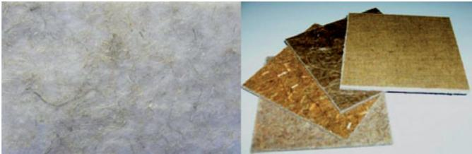
Abb. 5: Hybridvlies (l) und Beispiele für unterschiedliche Mischstrukturen (r)
