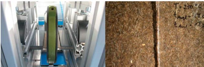
Abb. 6: Versuchsstand zum Heizelementschweißen (l) und Schweißnaht (r) [SKZ]
