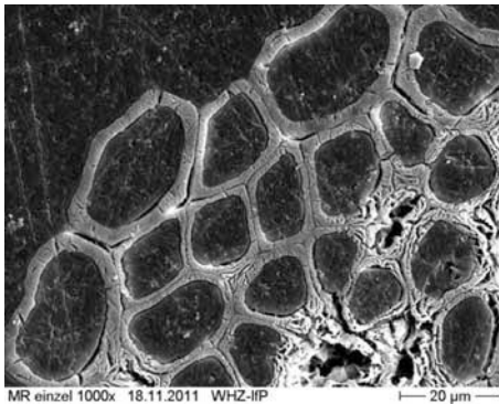
Abb. 20: Typische REM-Aufnahme von Meerrettichfaserbündeln (links) und Vergleich der Dichte mit anderen Naturfasermaterialien (rechts)
