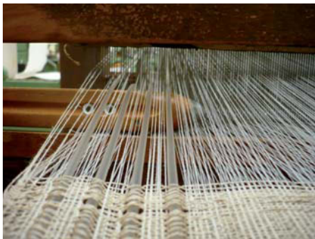
Abb. 11: Ausweben erster Muster links am Handwebstuhl mit Jacquardmustereinrichtung am ITL und rechts an einer automatischen Schaffwebmaschine
