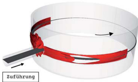
Abb. 18: Dreidimensionale Strömungsstruktur (Strömung entgegen Drehrichtung der Welle)
