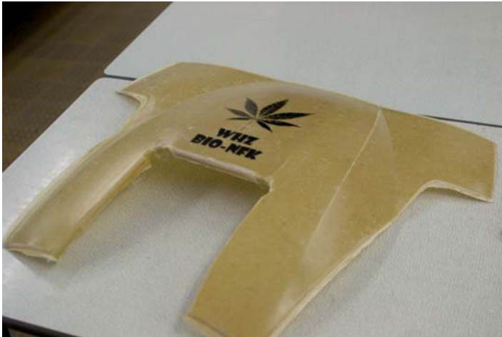
Abb. 19: Hergestelltes Karosseriebauteil des WHZ Formula Student Rennfahrzeuges nach dem Entformen
