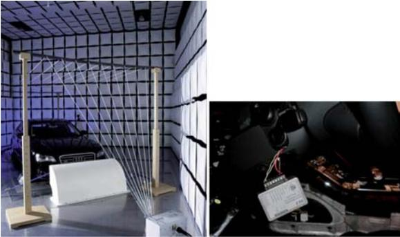
**Abb. 1:** EMV-Störfestigkeitsuntersuchung mit einer Fahrzeugstreifenleitung (links); FlexRay-Steuergerätenachbildung (Eigenbau WHZ, rechts)
