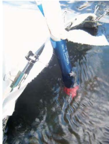
Abb. 11: Strömungsmessfühler
