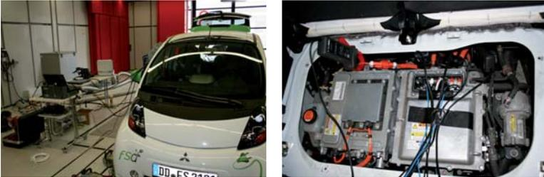
**Abb. 13:** Beispiele messtechnischer Untersuchungen an einem Elektrofahrzeug (Mitsubishi i-Miev)
