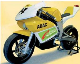
**Abb. 16:** E-Mini-Bike auf Basis Metrakit Mini GP 50
