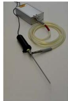
**Abb. 7:** Gesamtsystem mit Lichtquelle, Kameraeinheit und Endoskopadapter
