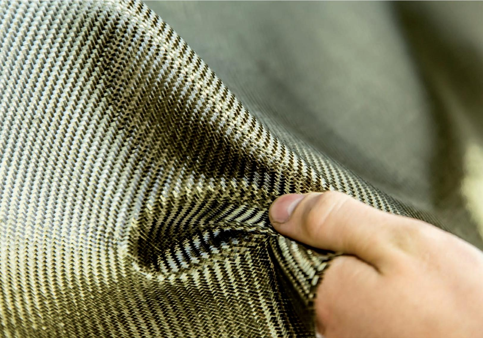
*Derzeit gibt es nur wenige Anbieter, die über ein umfassendes Know-how zu Faserverbundwerkstoffen mit Basaltfasern verfügen. Seit die Herstellung von Endlosfasern zur Serienreife gebracht wurde, lassen sich Basaltfasern textil verarbeiten und somit an unterschiedliche Anforderungen anpassen.*
