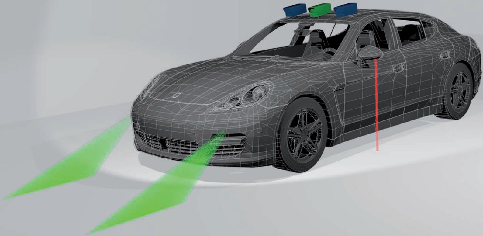
Die Abbildung zeigt die am Mess- und Testfahrzeug angebrachten Linienlaser mit den zugehörigen Kameras (grün), die in die Seitenspiegel eingebauten Ultraschall- und Infrarotabstandssensoren (rot) sowie die zwei Kameras auf dem Dach des Fahrzeugs (blau), die der Fahrraumerschfassung dienen.
