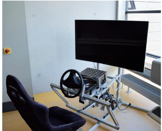
Der 2015 entwickelte Prototyp eines Fahrsimulationsarbeitsplatzes konnte nur zum virtuellen Befahren der Strecke genutzt werden. Entwürfe konnten an ihm nicht vorgenommen werden.
