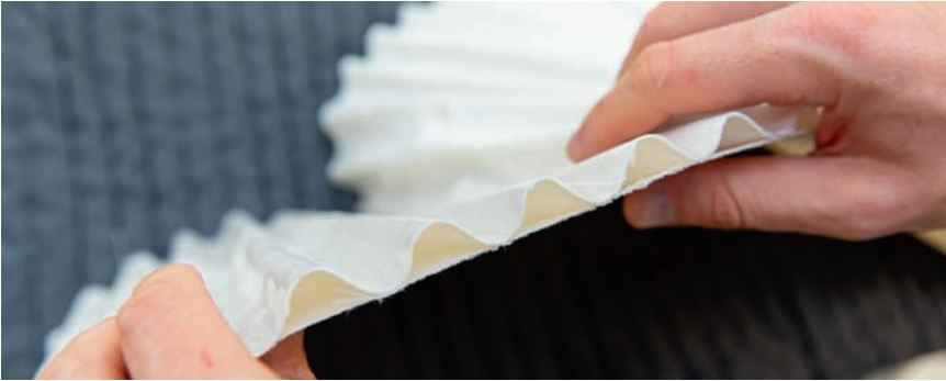
Zu sehen ist das Doppelgewebe, welches für die Herstellung des Deckensegels verwendet wird.
