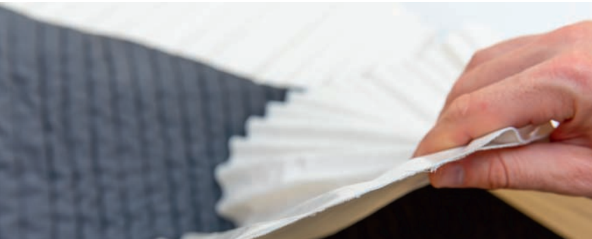
Beim Ziehen des Gewebes schließen sich die Luftkammern und die Fläche wird größer.
