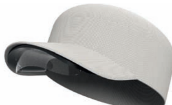
Dieses IT-Cap soll den „Greifraum“ des Nutzers erfassen und analysieren. Im Cap wird die Elektronik versteckt und eine Kamera sowie ein Display angebracht.
