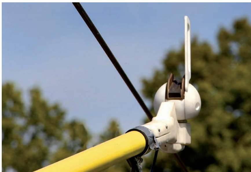
Einer der neuentwickelten Stromabnehmerköpfe mit aufgestelltem Leitblech beim Andraht-Vorgang.
