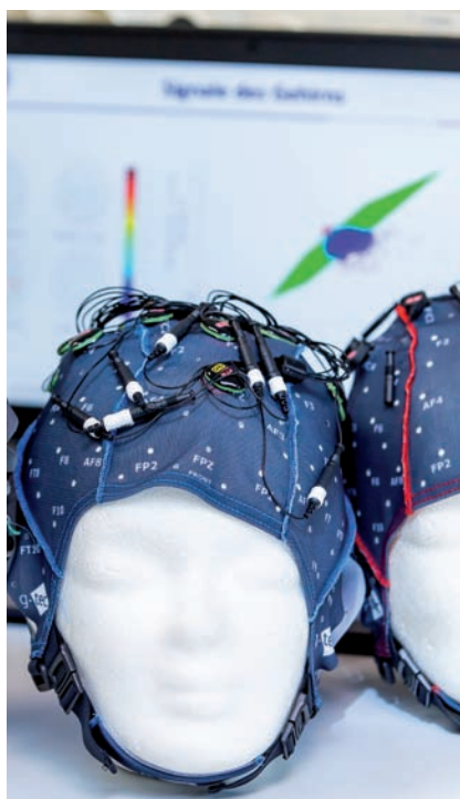
Mit solchen EEG-Kappen wird die Messung der Hirnströme durchgeführt.
