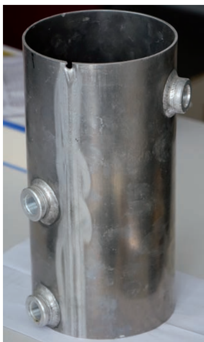
Abb. 1: Aluminium-Luftbehälter einer LKW-Bremsanlage.
