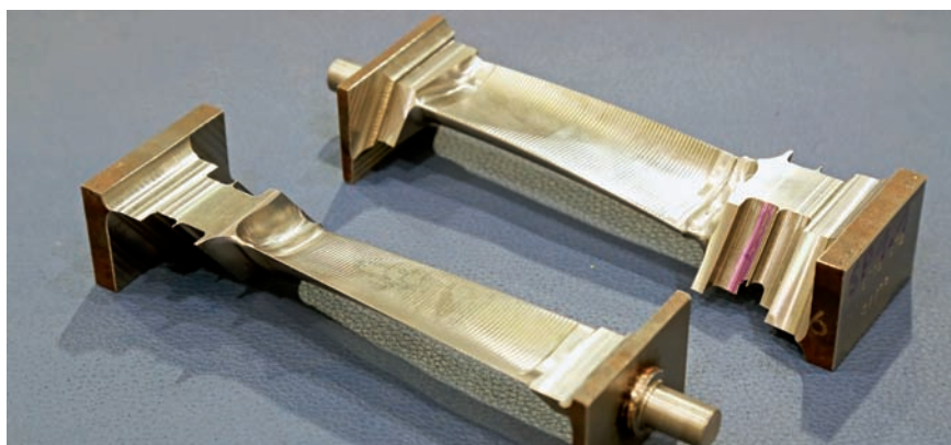
Die Ultraschallanlagentechnik für das geplante „PIN-Verfahren“ wird schon für die Nachbehandlung von Turbinenschaufeln genutzt.
