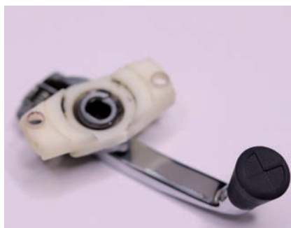
Dieser Schiebedachknopf wurde mittels SLS-Verfahren hergestellt.
